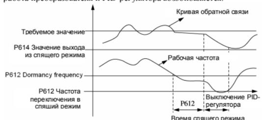
Пример: Требуемое значение 60% (0-100% соответствует 0-10В), значение выхода из спящего режима 80%, тогда фактическое значение выхода из спящего режима  $60\% \times 80\% = 48\%$  (соответствует 0-10В).
