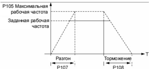
В нормальном режиме работы за время разгона или торможения по умолчанию принимается первое время разгона или торможения; переключение на другое время разгона или торможения производится с помощью многофункциональных входов.
