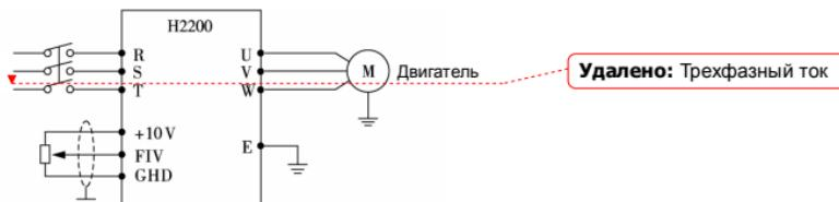
Прим.: Сигнал напряжения подается с помощью внешнего потенциометра (10 кОм).
