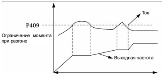
Значение 100% равно номинальному току преобразователя. Если в параметре P409 задано значение 0, ограничение момента при ускорении отсутствует и защита не выполняется.
