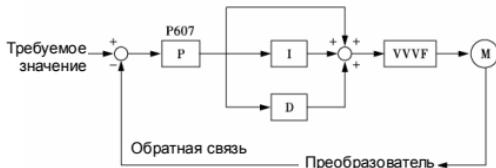
Общий метод PID-регулирования:
