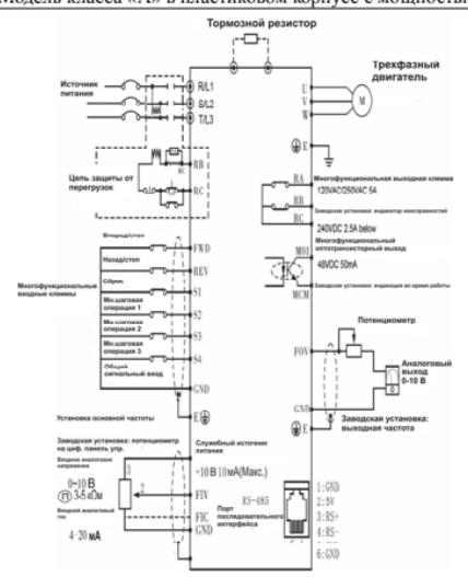
Примечание: Трехфазный вход 220В R, S, T/однофазный вход 220В R, S
