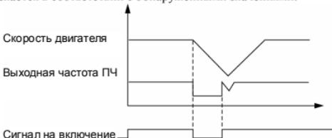
Пояснение: Когда ПЧ запускается в режиме поиска частоты, поиск выполняется сверху вниз в пределах заданного диапазона частот, что может вызывать сверхток при запуске, поэтому необходимо обратить внимание на настройку уровня тока (настройка 4.09) в соответствии с моментом инерции нагрузки.
