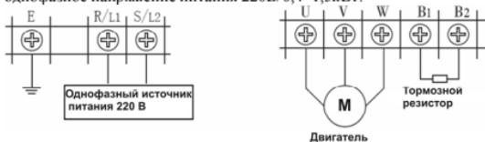
**4-2 Управляющие клеммы****4-2-1 Основная схема соединений**
