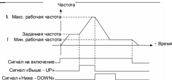
Пояснение: при изменении частоты с помощью сигналов «Выше/ниже – Up/Down», измененная частота не сохранится после отключения питания; ПЧ будет использовать заданное значение в параметре P100.
