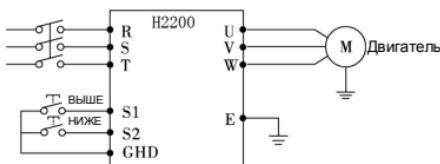
Параметр: Р317=5, функция «Выше - Up» присвоена клемме S1; Р101=4, выбран режим настройки частоты с помощью внешних клемм; F318=16, функция «Ниже - Down» присвоена клемме S2.
