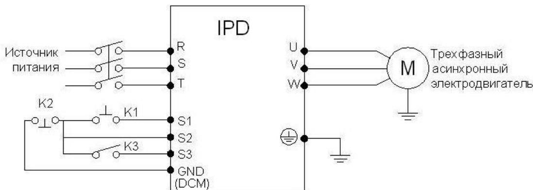
(2) Настройка параметра PF33 определяющего направления вращения
