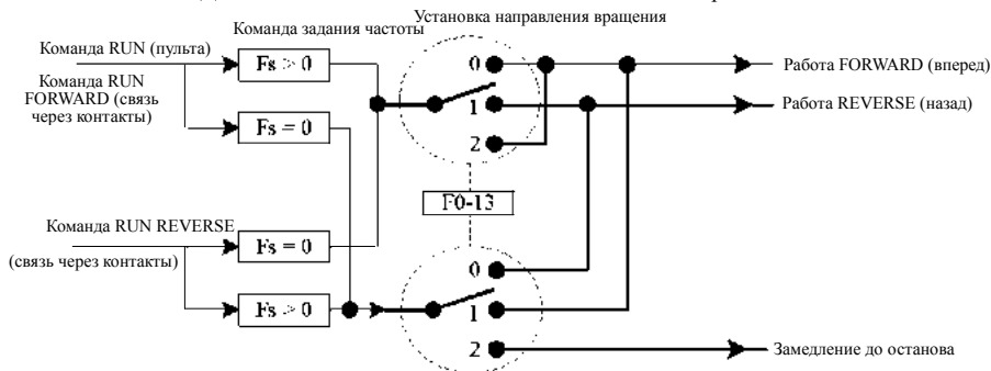
Рис. 4-22. Иллюстрация выбора направления вращения двигателя
