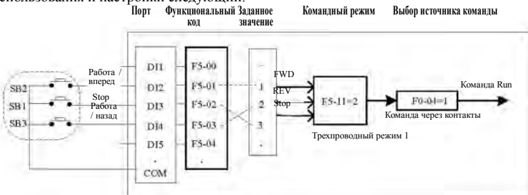
Рис. 4-8. Иллюстрация режима управления запуском-остановом через клеммы.
