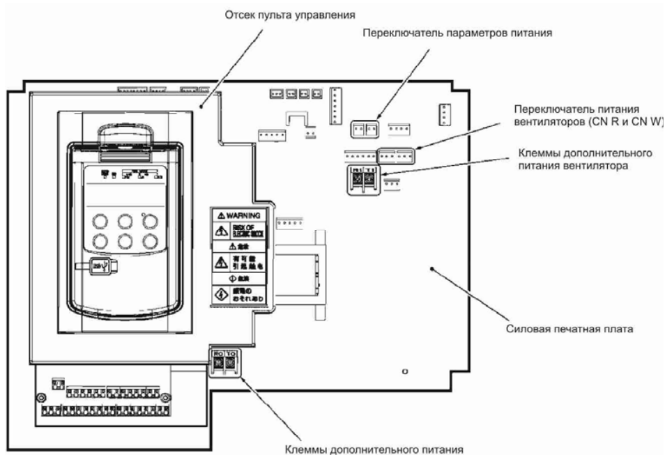
Рис. 2.6 Расположение переключателей и клемм дополнительного питания
