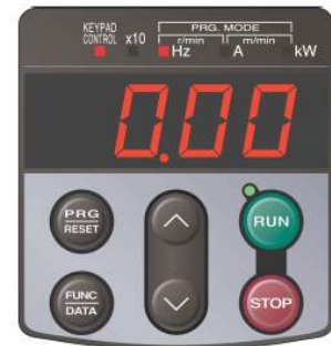
Рис. 4.3 Показания дисплея при подаче питания на ПЧ
