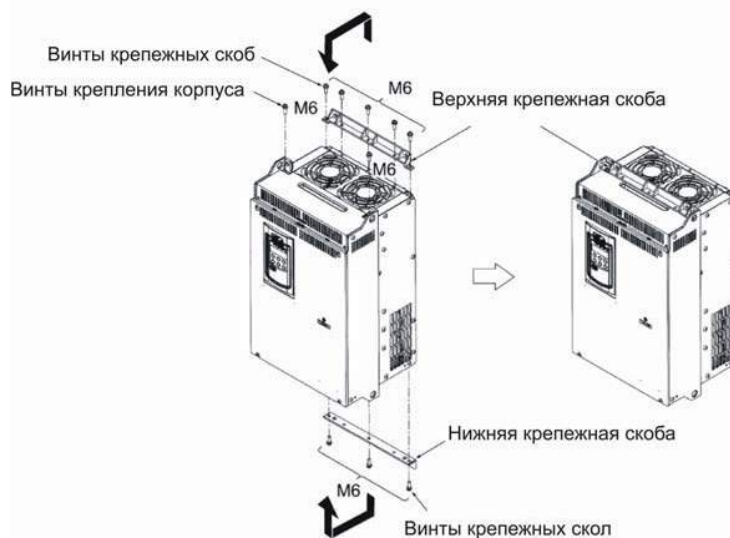
Рис. 2.3 Перестановка крепежных скоб
