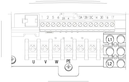
Трехфазная модель (3/PE) с фильтром
