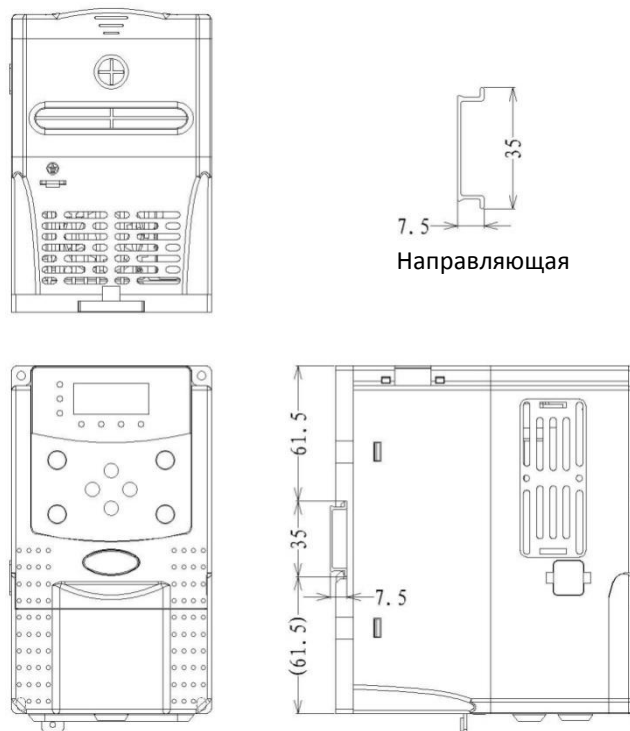
Рисунок 2-5. Габариты преобразователя и размеры монтажных отверстий
