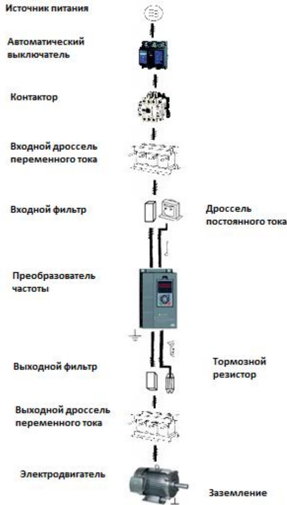
Рис 3-1 Подключение периферийных устройств к преобразователю
