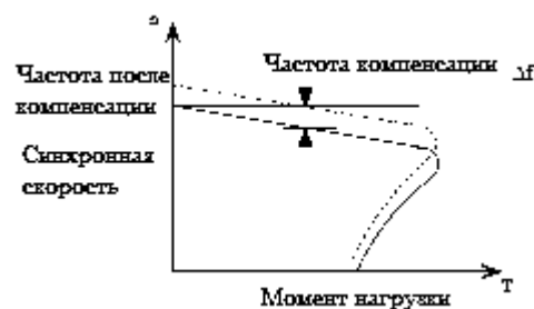
Рис. 6-11 Автоматическая компенсация скольжения
