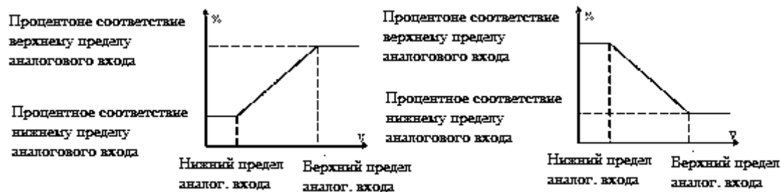
Рис. 6-18 Линейная кривая аналогового входа
