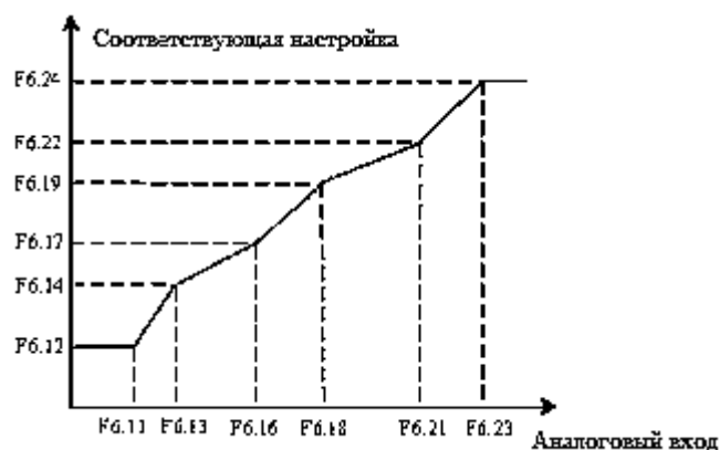
Рис. 6-17 Нелинейная кривая аналогового входа
