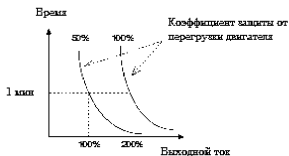
Рис. 6-27 Кривая защиты двигателя от перегрузки
