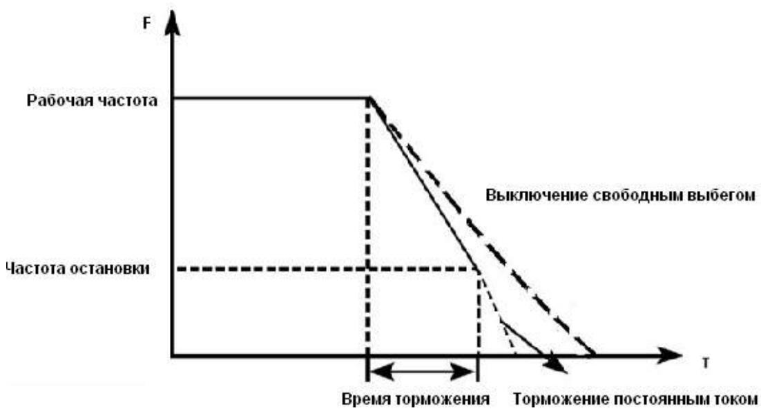
Вместе с выбором режима остановки необходимо определить целесообразность торможения постоянным током на завершающем этапе движения. При этом следует установить величину постоянного тока при торможении, время замедления постоянным током (отличное от нуля) и другие параметры, в противном случае в конце торможения остановка будет происходить в режиме свободного выбега.
