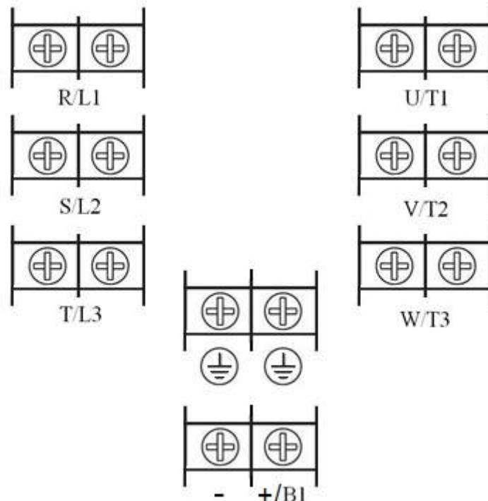
Момент затяжки винтов на силовых клеммах преобразователя 1,4 Н·м.
