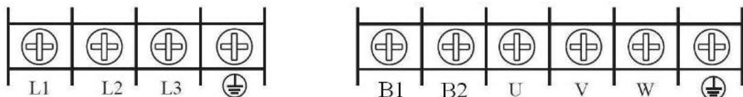
Тип корпуса В (18,5 кВт – 45 кВт)
