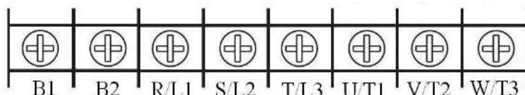
Тип корпуса С (55 кВт – 185 кВт)
