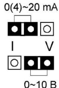
Аналоговые выходы FOC и FIV являются универсальными и поддерживают сигналы (0-10В / 0(4)-20mA). Для выбора режима работы выхода FOC используется перемычка J4. Для выбора режима работы выхода FOV используется перемычка J8.
